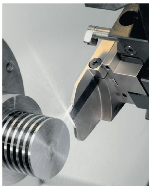
附図 3 性能の向上しつつある突切りバイト (内部切削油剤供給機能付き) - ARNO 社 (特許)、2021 年
